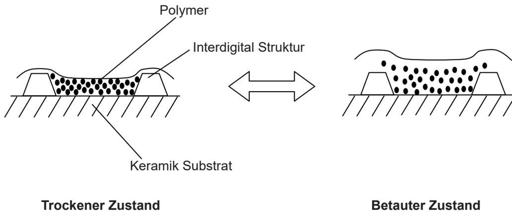
Die feuchtesensitive Beschichtung des Sensors besteht aus Grafitpartikeln, die in einem Polymer eingebettet sind. Das Polymer hat die Eigenschaft, dass es durch Feuchteeinwirkung aufquillt.
